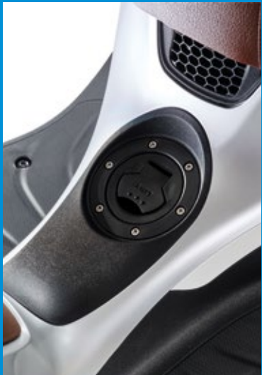
TAPPO SERBATOIO SUL TUNNEL CENTRALE
